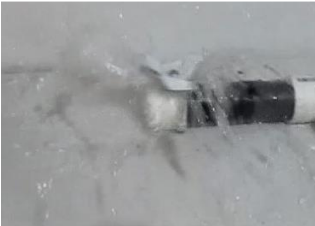
Figura F-12. - Aspersor de Hélice en Funcionamiento a Presión de Menos de 1 psi
