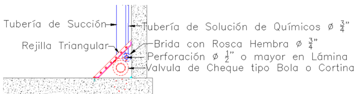
Vista de Corte Transversal
